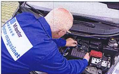
Slangen, der fører brint ind i motoren, skal føres ind bag luftmængdemåleren.
