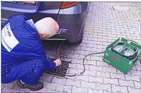
For at kunne måle på så mange parametre som muligt, blev der benyttet en 5-gastester i forbindelse med testen.
